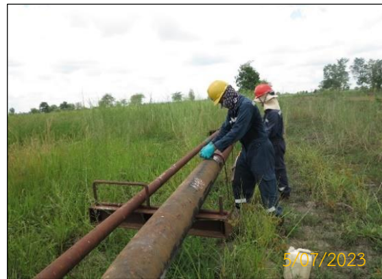
ภาพที่ 2.3-2 การตรวจสอบความหนาแน่นของท่อ
